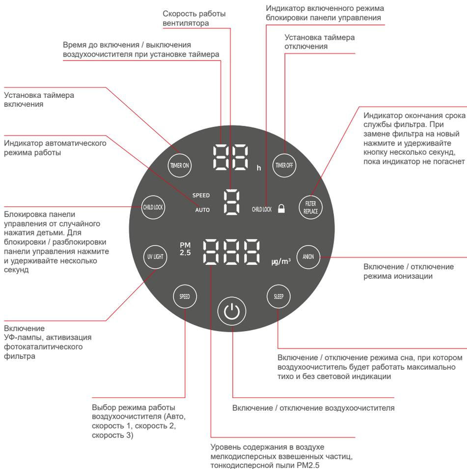
Воздухоочиститель HealthAir UV-03 оснащен сенсором контроля качества воздуха, анализирующим уровень содержания в воздухе взвешенных частиц PM2.5.
